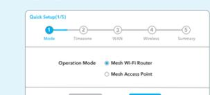
Quando se completan todas las configuraciones, el enrutador se reiniciará. Espere a que el LED se vuelva blanco fijo, lo que significa que la configuración se realizó correctamente y está conectado a Internet.
