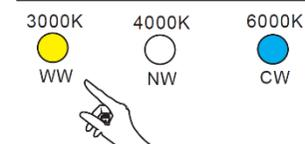
SELECT BY SLIDING THE SLIDER ON THE POWER SUPPLY
